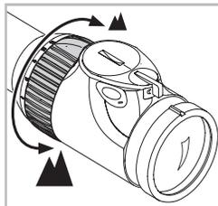
En tournant la bague de réglage du grossissement à 180°, vous obtenez graduellement le grossissement de votre choix. La graduation oblique permet de lire le réglage facilement et aisément. Pour faciliter l'orientation,
