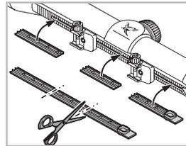
La couvre-rail ci-joint sert à protéger les parties à rail libres. Sa conception s'adapte à la dimension requise et il s'enfonce dans le rail par simple pression de la main.
