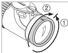
Tournez la bague de réglage de la dioptrie entièrement vers la gauche ① (dans le sens horaire inverse) puis vers la droite ②, jusqu'à ce que le réticule soit le plus net possible.
