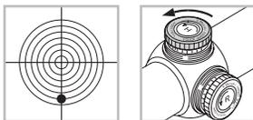
Tournez la vis moletée du réglage vertical dans le sens de la flèche H – dans le sens inverse des aiguilles d'une montre.
