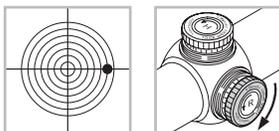
Tournez la vis moletée du réglage latéral dans le sens inverse de la flèche R – dans le sens des aiguilles d'une montre.
