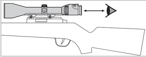
Tenez compte de la distance oculaire imposée si une lunette de visée est installée sur l'arme (voir fiche signalétique pour les mesures).
