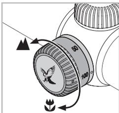
La tourelle de parallaxe vous permet d'effectuer des réglages d'une précision optimale pour toutes les distances d'objectif et d'éviter les erreurs d'objectif dues à la parallaxe.
