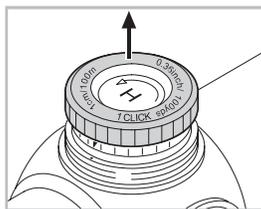
2. Faites ensuite coïncider le repère du réglage zéro de la vis moletée avec le point de repère de la lunette, et cela en tournant à gauche ou à droite la vis moletée.
