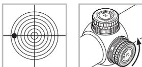
Tournez la vis moletée du réglage latéral dans le sens de la flèche R – dans le sens inverse des aiguilles d'une montre.
