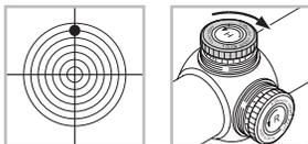
Tournez la vis moletée du réglage vertical dans le sens inverse de la flèche H – dans le sens des aiguilles d'une montre.
